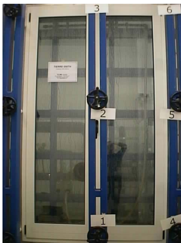
Foto 2: Campione durante la prova di tenuta all'acqua
