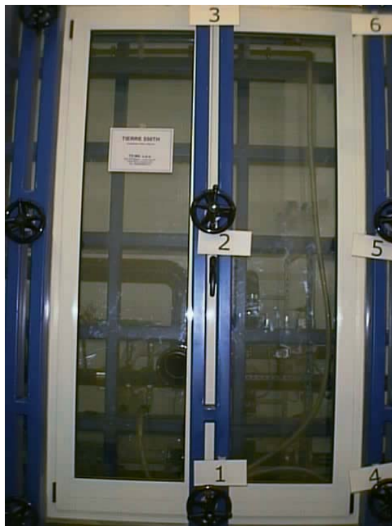
Foto 1: Campione sottoposto a prova nell'assetto sperimentale prima delle prove
