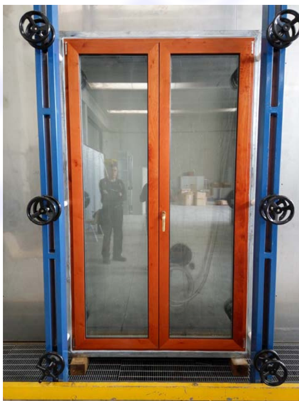
Foto 2: Foto del campione durante la prova di tenuta all'acqua
