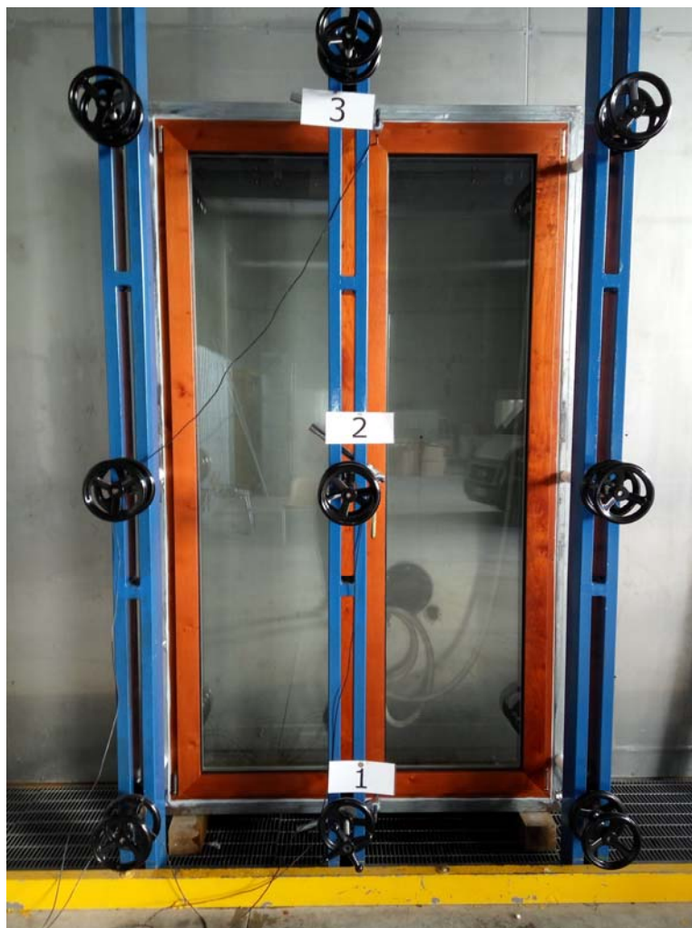
Foto 3: Campione durante la prova di resistenza al carico del vento (prova di deformazione)
